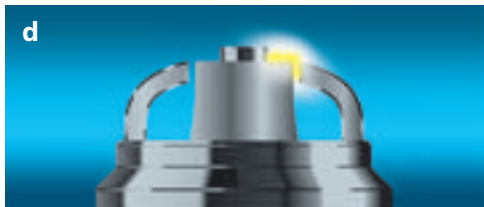
Seitenelektrode – Isolatoroberfläche – Mittelelektrode
